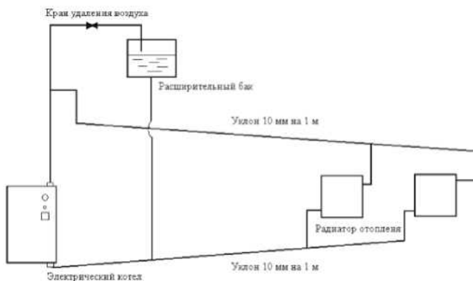
Рис. 4 - Установка электрического котла с открытой системой отопления
